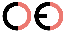
Virheellinen CE-merkki (liian kaukana)
