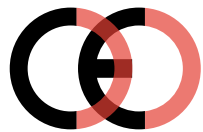
Virheellinen CE-merkki (liian lähellä)
